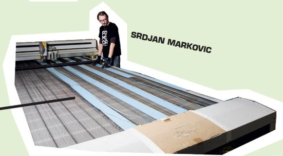
Los rollos se desenrollan en la mesa del láser antes de ser cortados. El corte de la piel varía según las dimensiones deseadas (longitud, anchura, forma).
