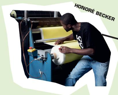
El primer paso consiste en cortar el rollo grande (RG) en rollos pequeños (RP). El número de RP y su ancho varía según el tipo de piel deseada. Una vez que se crea el RP, se agrupan de extremo a extremo para facilitar las operaciones que siguen (un paso también llamado colocación en bandejas).
