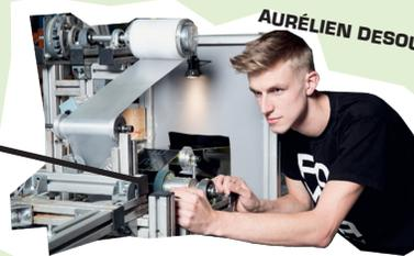
Auch hier werden die KR ausgerollt und bilden einen langen Streifen auf der Unterseite des Fells, auf dem sich zwei verschiedene Schichten Klebstoff befinden.
