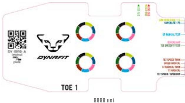
Maschera di montaggio per puntale 1 per la dima di montaggio modulare. Adatto per i puntali dei seguenti attacchi: Low Tech Race 115, Superlite 175, TLT Expedition, Blacklight, Blacklight Long Travel, TLT Speed, TLT Speedfit, TLT Speedfit Test, TLT Speed Turn, Speed Radical, ST Radical Turn, ST Radical, ST Radical Long Travel.
