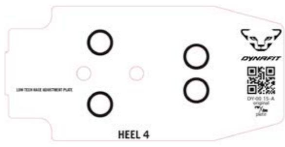
Maschera di montaggio per talloniera 4 per la dima di montaggio modulare - adatta solo al Low Tech Race Adjustment Plate.
