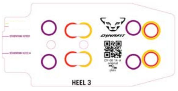
Maschera di montaggio per talloniera 3 per la dima di montaggio modulare. Adatta per le talloniere dei seguenti attacchi: ST Rotation 10, 12 & 14, ST Rotation 10 Rental.
