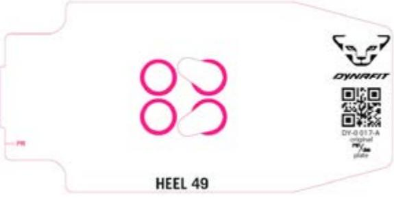
Placa de talón 49 para el montaje modular, compatible solo con la P49.
