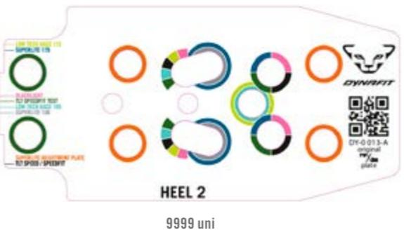
Placa de talón 2 para el montaje modular. Las siguientes fijaciones son compatibles con el talón: Low Tech Race 105, Low Tech Race 115, Superlite 150, Superlite 175, Blacklight, Blacklight Long Travel, TLT Speed, TLT Speedfit, TLT Speedfit Test, Superlite Adjustment Plate.
